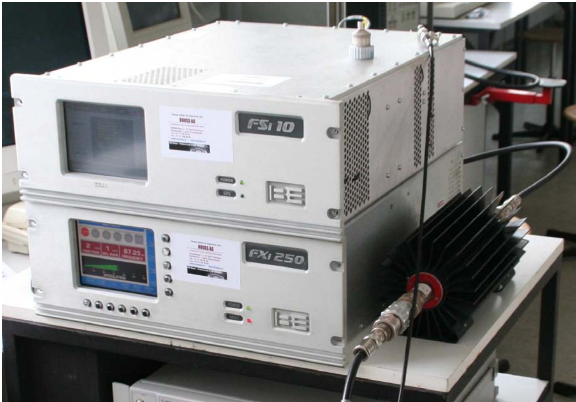
Abbildung 4.9: Foto eines HD-Radio-Senders kleiner Leistung
