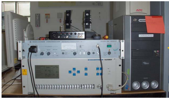
Steuerrechner und Sender im Standort „Am Rotenberg“ Zugriff auf Sendefrequenz & Einspielung der Audio-Signale
