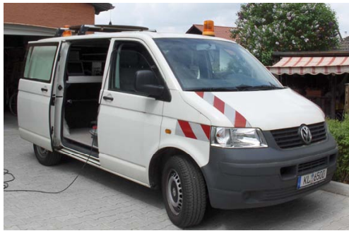
Messbus der FH Kaiserslautern mit. \lambda/4 -Rundstrahler, ca. 2,2m ü. Gr.
