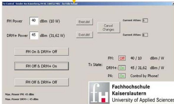
Steuerrechner Sender „Am Kaiserberg“ Zugriff auf Modulation, Sendeleistung & Einspielung der Audio-Signale
