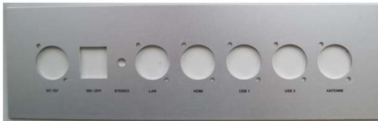
Abbildung 2.4.: unbestückte Anschlussplatte
