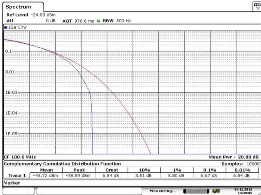
Abbildung 5.17.: 16-QAM Sendesignal F-F-U, Crest-Faktor
