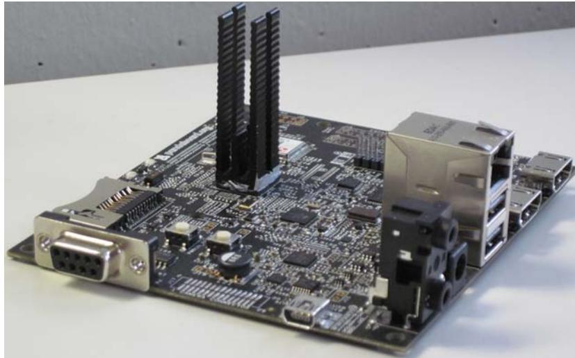
Abbildung 2.6.: *pandaboard ES* mit Kühlkörper auf der CPU
