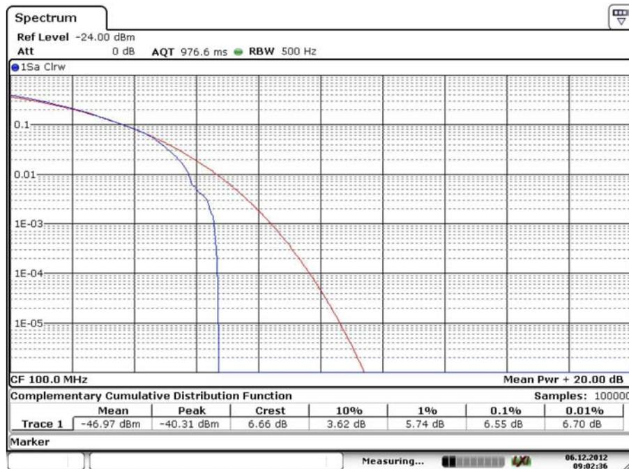
Abbildung 5.11.: 16-QAM Sendesignal F-S-R, Crest-Faktor
